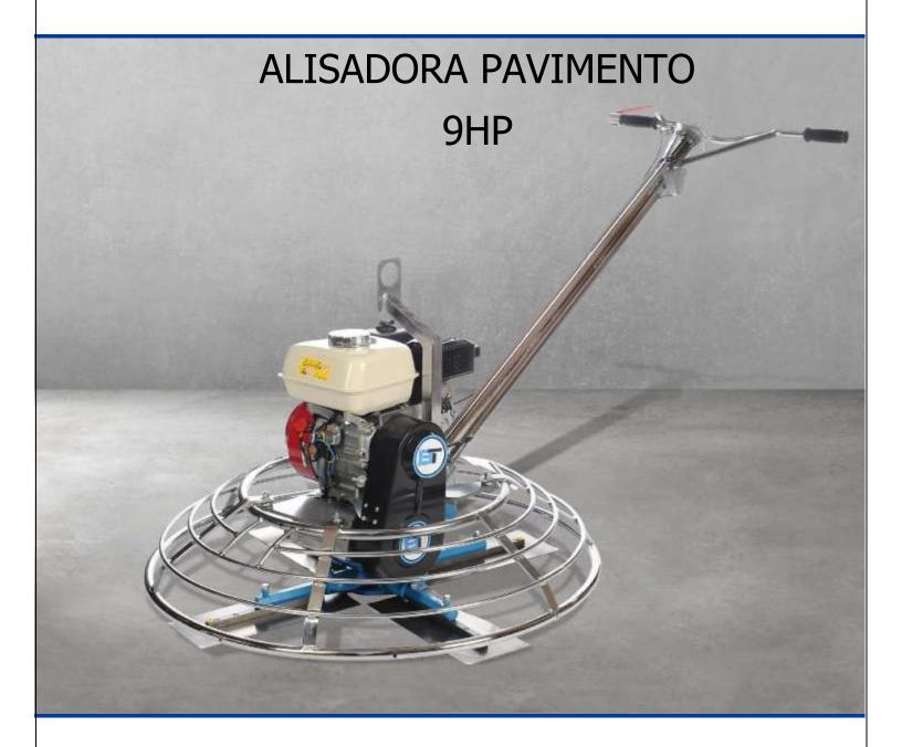
Alisadora fácil de operar para lograr acabados precisos. Este equipo reemplaza el allanado manual y es ideal para afinar pavimentos de hormigón. Cuenta con un control central de ajuste de ángulo de trabajo de aspas y además el comando de aceleración y on/off en el timón de operación.
